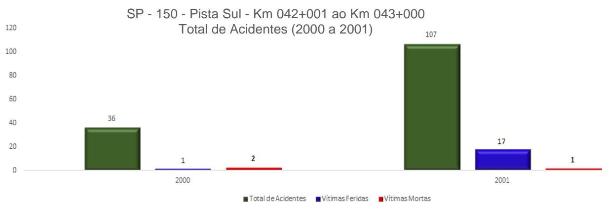
Gráfico 01 - Quantidade de acidentes no período anterior a operação da área de escape do Km 042+700 – SP-150 Pista Sul.
