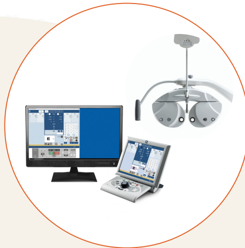
Refrator com sistema que permite a Teleoftalmologia
